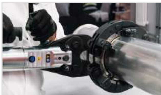
Assemblaggio pressatura n°1 / Press assembly phase 1
